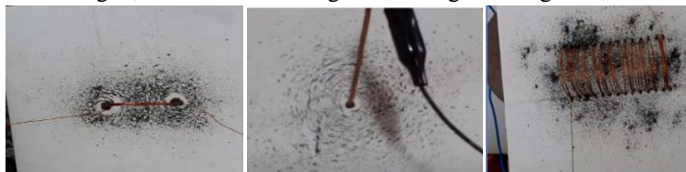
Hình 1. Một số TN tự tạo về từ phổ của dòng điện chạy trong dây dẫn tròn, thẳng và ống dây (nguồn: tác giả)
