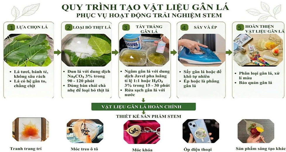
Hình 1. Quy trình tạo vật liệu gân lá phục vụ HĐTN STEM (Nguồn: Tác giả)
